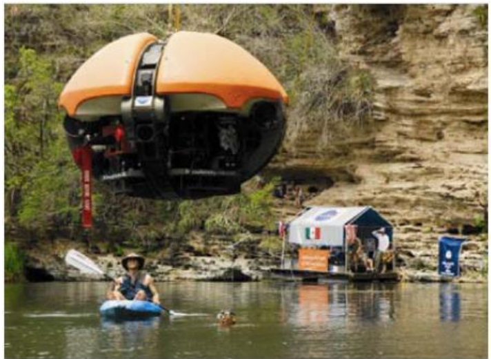
Fig. 3 – Il DEPTHX in manovra per immergersi in 319 metri d'acqua nel cenotes Zacatòn.
