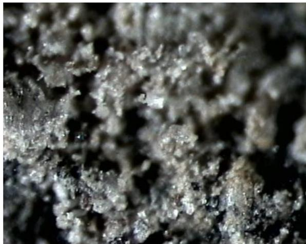
**Fig. 4 - Ingrandimento esagerato del campione di figura 3 (la messa a fuoco evidenzia solamente la parte più superficiale dell'incastellatura del quarzo che è stata privata di gran parte del cemento di carbonato di calcio; base della foto 600 micron). (Foto E. Merlak)**
