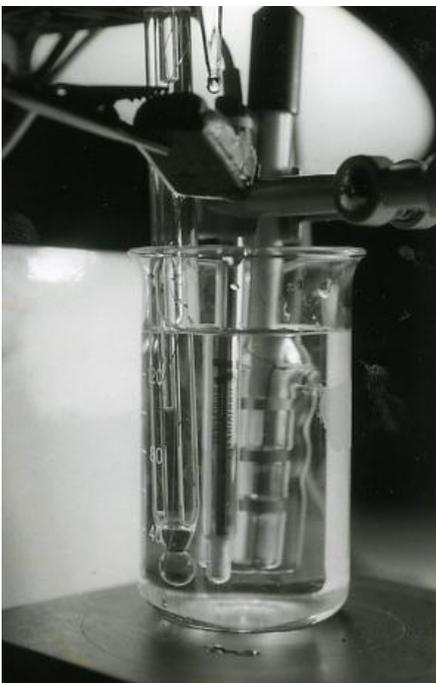
**Fig. 2 – Campione di arenaria sottoposto a percolazione controllata in laboratorio con acqua acidificata con  $\text{CO}_2$ . (Foto E. Merlak)**
