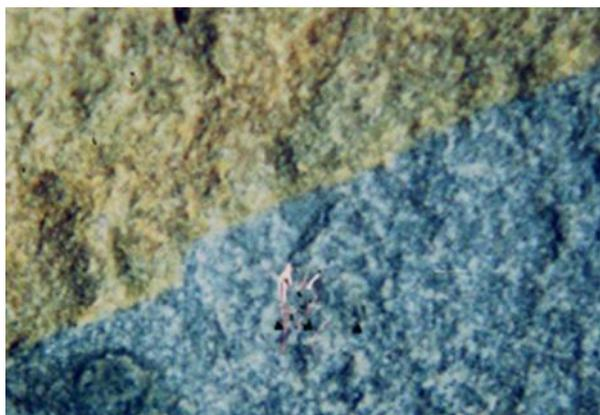
Fig. 1 - Campione di arenaria a cemento calcareo parzialmente alterata (base della foto 11,5 cm). (Foto E. Merlak)
