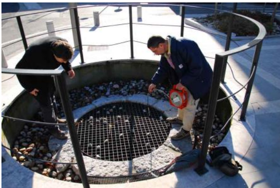
Misurazione della profondità dell'acqua tramite sonda elettrica (Foto Roberto Ferrari)
